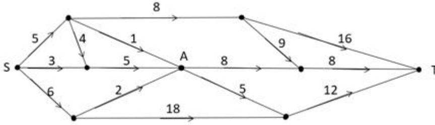
求 S 点到 T 点的最短距离，可以先分两部分考虑，如图所示，即 S 点到 A 点，再由 A 点到 T 点。从 S 点到 A 点，共有 4 条路线，显然最短距离为  $5 + 1 = 6$  千米，从 A 点到 T 点，共有 2 条路线，显然最短距离为  $8 + 8 = 16$  千米，此时最短距离为  $6 + 16 = 22$  千米。虽然从 S 点出发不经过 A 点，也有其他路线到达 T 点，但均大于 22 千米，即水从 S 点流到 T 点最短的距离为 22 千米。
